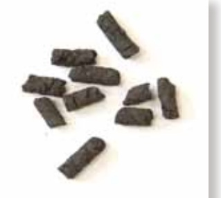
▼写真3 低温炭化技術で製造した汚泥炭化燃料
